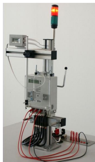
Upevnenie elektromera na stanici ELMA 8301
