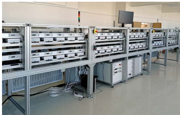
Plne automatizované testovacie zariadenie ELMA so zákaznickým horizontálnym umiestnením elektromerov
